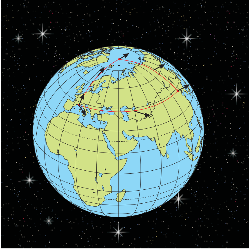
Fig. 7.2. Transport parallèle d'un vecteur sur une surface courbe
